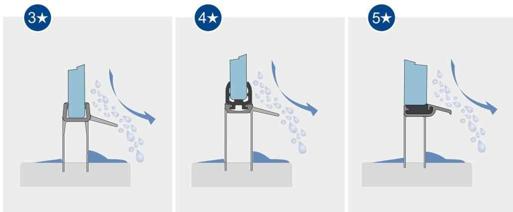
**Attenzione!** Questa guarnizione può essere utilizzata al posto di quella standard inclusa nella fornitura. Si ricorda che i box doccia con guarnizione standard e listello antiallagamento integrato sono stati testati ai sensi della norma EN 14428. Eventuali modifiche a tale configurazione compromettono la protezione contro gli spruzzi.
