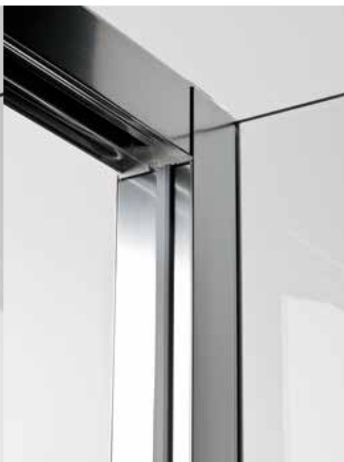
dukessa 3000 - продвинутая технология профилей, фиксируемых к стене и регулируемых при помощи телескопического винта, не только гарантирует плотное закрывание даже при наклоне стен, но и заметно упрощает установку. Кроме того, отсутствуют видимые винты.
