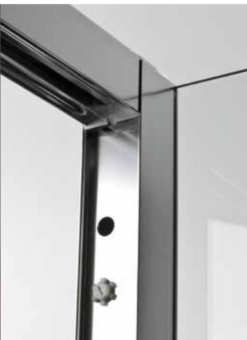
dukessa 3000 - продвинутая технология профилей, фиксируемых к стене и регулируемых при помощи телескопического винта, не только гарантирует плотное закрывание даже при наклоне стен, но и заметно упрощает установку. Кроме того, отсутствуют видимые винты.
