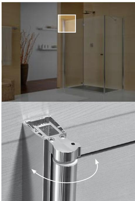
**multi-S 4000** - Accesso illimitato semplicemente andando a discostare gli elementi in vetro. Il profilo della cerniera può essere volta di 90° sia verso l'esterno, sia verso l'interno.
