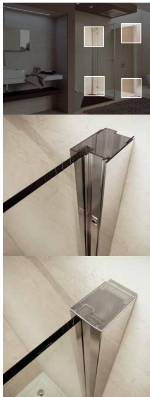
**gallery 3000** - Il telaio della porta viene fissato nel profilo a muro con un sistema unico, denominato "girofix": veloce e semplice. Il montaggio diventa un piacere: è sufficiente girare la vite speciale "girofix" di 90° e la cabina è fissata! Dall'esterno dei profili si accede facilmente al meccanismo di fissaggio, anche in caso di interventi post-installazione.
