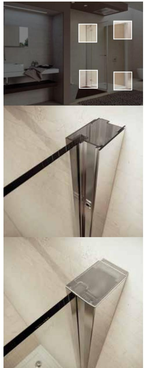
**gallery 3000** - Das Rahmenprofil wird mit einer speziellen „girofix-Schraube“ am Wandprofil fixiert - schnell, einfach und zeitsparend! Ein Dreh' der girofix-Schraube um 90° genügt und das Rahmenprofil sitzt fest. Die „girofix-Schraube“ an der Außenseite des Profils ist leicht zugänglich und macht ein Nachjustieren damit jederzeit möglich.
