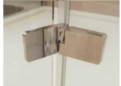
**gallery 3000** - Die Türen der gallery 3000 sind mit einer funktionalen Hebe-/Senktechnik versehen und werden beim Öffnen automatisch um einige mm angehoben. Das Abtropfgummi wird dadurch vor Abscheuern geschützt und die Tür schließt die letzten 10 bis 20 cm selbsttätig.
