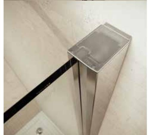
**gallery 3000** - El marco de la puerta se fija al perfil de la pared con un sistema único, denominado "girofix", rápido y simple. La instalación se convierte en un placer: es suficiente girar el tornillo especial "girofix" 90° y la mampara está fijada ! Desde la parte externa de los perfiles se accede fácilmente al mecanismo de fijación, también en el supuesto de eventuales reajustes post-instalación.
