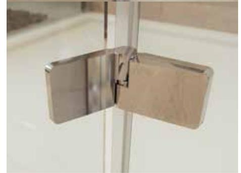
**gallery 3000** - Las puertas de la gallery 3000 new están todas provistas del mecanismo de bisagras auto elevables, que se elevan algunos mm durante el movimiento de apertura, protegiendo al perfil vierte aguas del desgaste. Además, la puerta tiene el sistema de cierre amortiguado, self closing system, en los últimos 10 - 20 cm.
