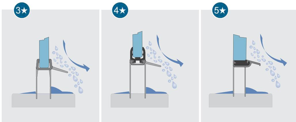
**Attention !** Ce joint peut être utilisé à la place du joint standard normalement fourni. Se rappeler que les cabines de douche avec joint standard et profilé anti-débordement intégré ont été testées conformément à la norme EN 14428. D'éventuelles modifications à cette configuration compromettent la protection contre les éclaboussures.
