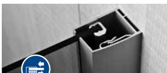
**Porte con regolazione integrata nel cristallo** La regolazione a parete di 25 mm degli elementi fissi e laterali avviene grazie alla regolazione lineare del vetro temperato nel "profilo a muro".
