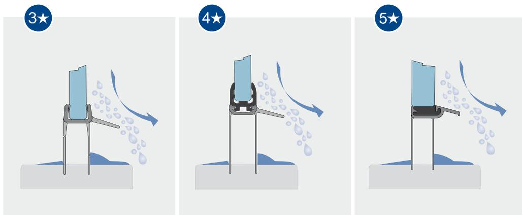
**Achtung!** Diese Dichtung kann anstatt der mitgelieferten Standarddichtung eingesetzt werden. Wir weisen darauf hin, dass die Duschatbrennungen mit Standarddichtung und verbauter Schwallschutzleiste nach EN 14428 getestet wurden. Veränderungen dieser Konfiguration führen zu einem geringeren Spritzwasserschutz!
